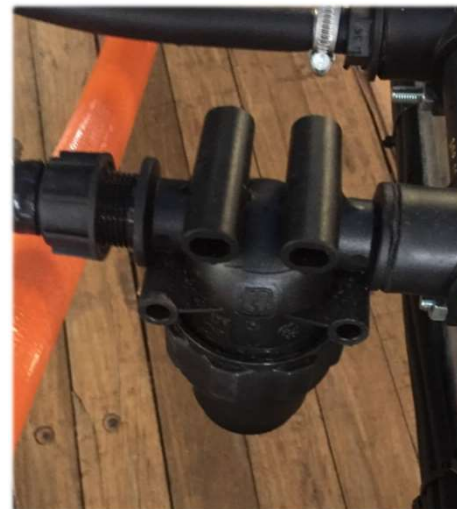
Filtro para água dos tanques
